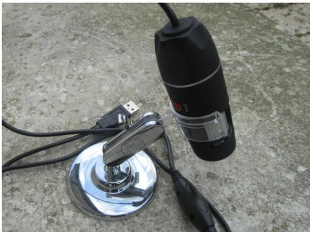
Figure 1. Mon matériel, un microscope USB
