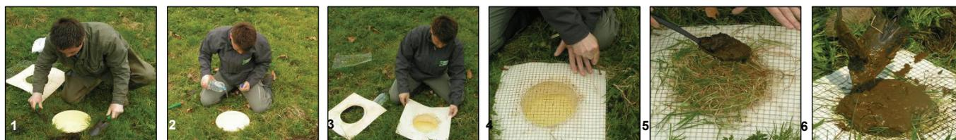
1. la bassine est enterrée au niveau du sol ; 2. mise en place du liquide conservateur ; 3. installation de la protection plastique ; 4. installation de la grille, puis fixation du dispositif à l'aide de piquets de tente ; 5. si l'appât est très liquide, on peut recouvrir la grille avec de l'herbe ; 6. mise en place de l'appât
